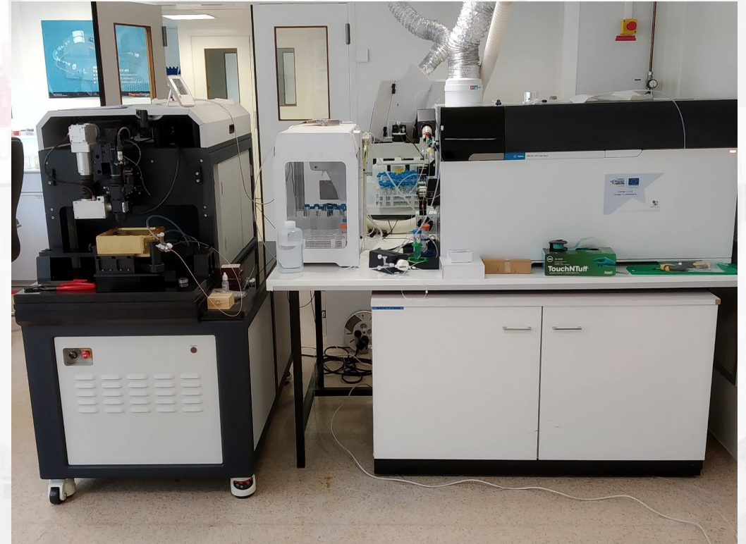
LA+QQQ-ICP-MS Teledyne CETAC® Analyte Excite + Agilent 8900
